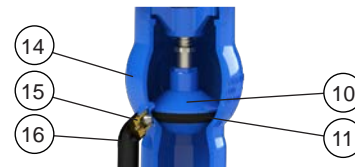
Sistema de drenagem
